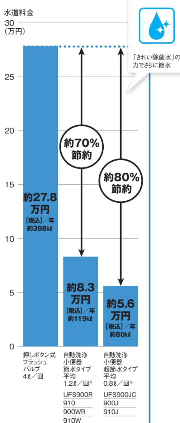
〈平均洗浄水量〉器具あたり80回/日 ●超節水タイプ(「きれい除菌水」搭載 UFS900JC・900J・910J):0.8ℓ(毎回洗浄:0.5ℓ、排水管洗浄:0.3ℓ)
