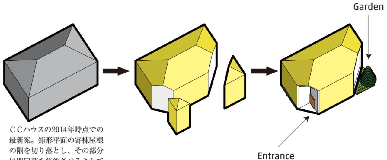
CCハウスの2014年時点での最新案。矩形平面の寄棟屋根の隅を切り落とし、その部分に開口部を集約させることで、敷地内の奥まったところに窓ができる。どこに建てられても成り立つ窓の配置として考案された。
