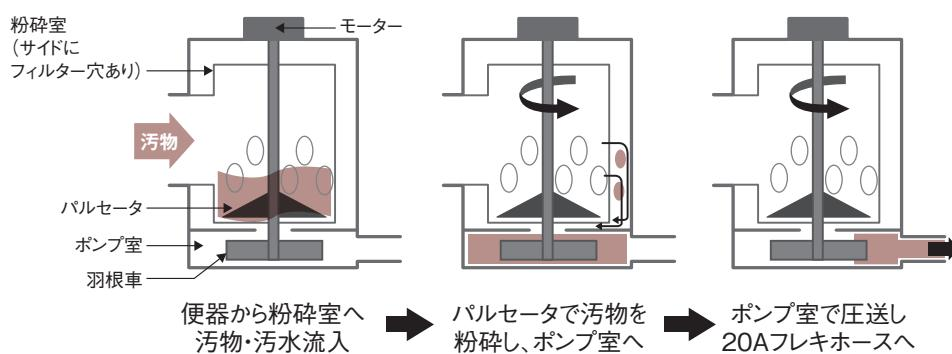
パルセータ形状と軸形状を工夫し、汚物・ペーパーを確実に粉碎しつつモーターがロックしないポンプを実現しました。
