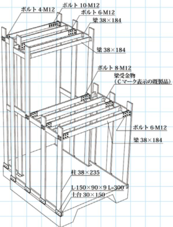
ツーバイ材を平使いした柱を90cmピッチで立て、両側から構造用合板で挟む。柱脚を剛接合とすることで、厚さ62mmの薄い壁を成立させた。構造設計家・佐藤淳さんの提案により、可能となったアイデア。
