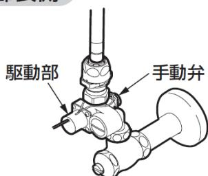
湯側・水側2カ所の手動弁を右回りいっぱいに回し、開状態にする。
