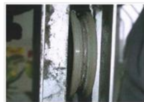
戸車の磨耗 障子が動きにくくなります。
