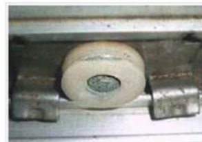
網戸戸車磨耗、変形 網戸が動きにくくなります。
