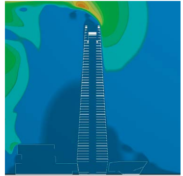
「臺北南山廣場」(2018)。 設計/三菱地所設計。台北市信義区。写真下/外観。右手に台北101。上/風環境のシミュレーション。地上へのビル風が防止され、これを空に流している。
