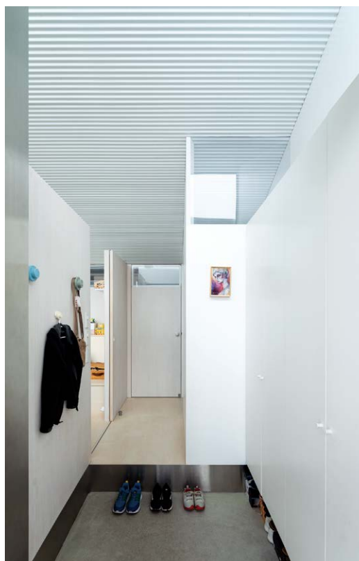
玄関。波板の天井が陰影をつくりながら光を奥に届けている。
