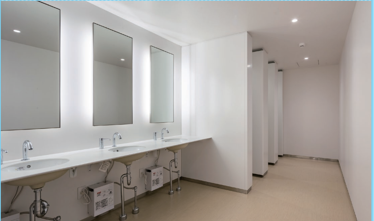
女子トイレ全景。セキュリティ上、個室の壁を天井まで立ち上げている。
