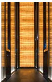
オフィスのエレベータホール。壁はオニキスの光壁。
