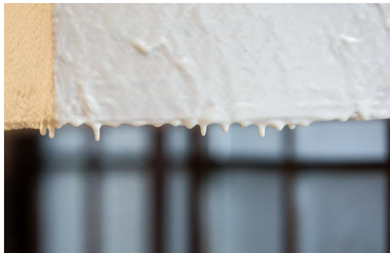
↓ 什器塗装のつらら。白い顔料にエポキシ樹脂を混ぜてムラを出し、固まるスピードを調整した。
