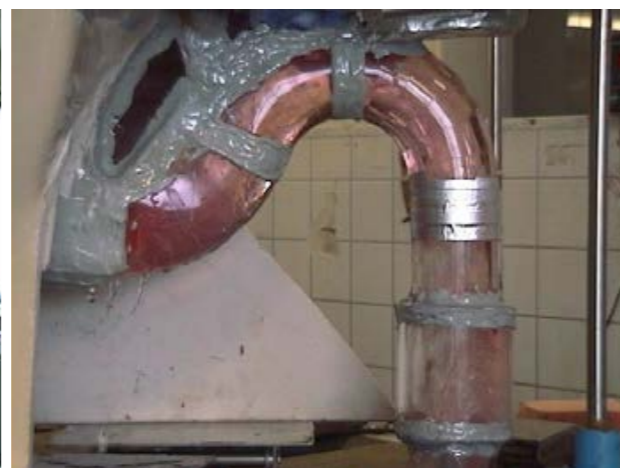
トラップ部を透明にした実験用便器
