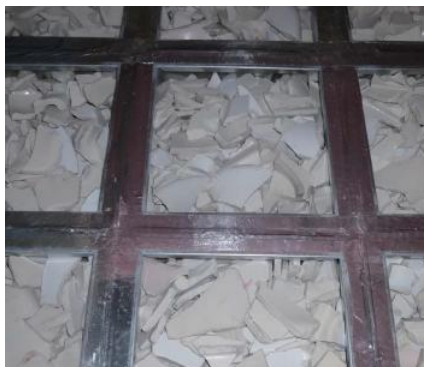
陶器の破片を再利用した蓄熱材
