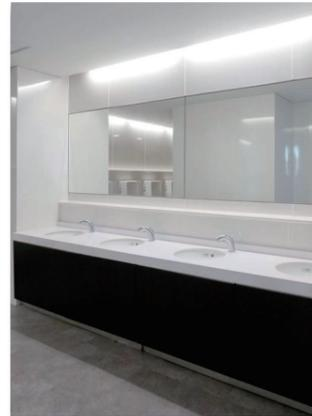
「光と風」をテーマにした明るく開放感のある校舎にふさわしい、白を基調にしたトイレ。洗面コーナーには、非接触で利用できる発電タイプの自動水栓を設置。このトイレは、特別教室と普通教室に隣接している。
