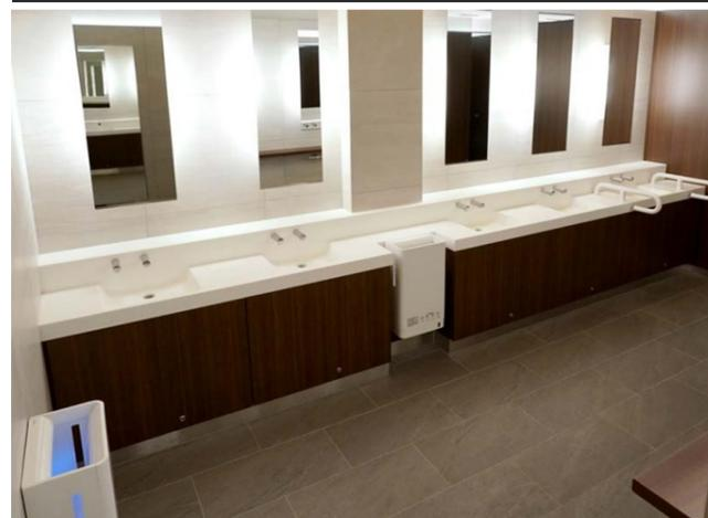
カウンターは、水濡れを心配せずに荷物が置くことができるように、ドライエリアのあるツインデッキカウンターポウル一体タイプを設置。継ぎ目がなく衛生的で清掃性にも優れている。
