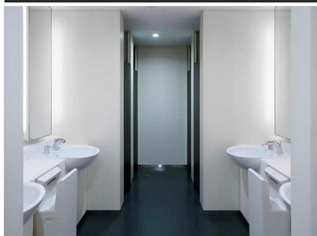
動線と空間の活用から、通路両側に洗面コーナー、奥にトイレブースを配置。手洗い後の床への水はねを抑える配慮として洗面器の間に、温風乾燥機を併設している。
