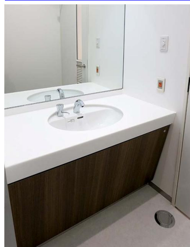
ダークブラウンの木目調パネルがアクセントとなっている教職員男性トイレ。水栓金具は、ノンタッチで水の出し止めができる自動水栓を採用。
