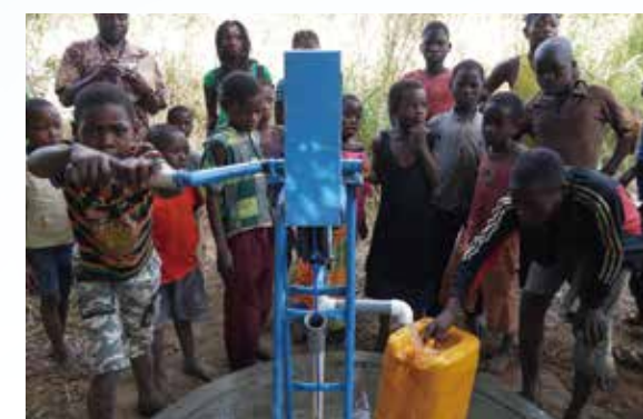
ニビコ村に設置したロープポンプ式井戸
