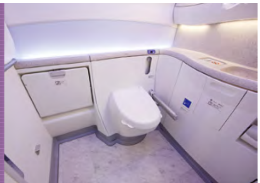
航空機向け温水洗浄便座「ウォシュレット®」(写真提供: JAL)
