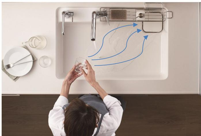
すべり台シンクは、排水口をシンク奥の隅に配置し、排水口に向かってシンク底に3°の傾斜をつけることで、水やゴミを1箇所に集めます。排水口にも傾斜があるため水がたまりにくい形状になっています。さらに目皿の抗菌※3防カビ※4樹脂の効果でヌメリの発生を抑えます。その他、「網かご」はゴミが引っかからず、1箇所にまとまりやすい形状なので、ゴミ捨てが簡単です。
