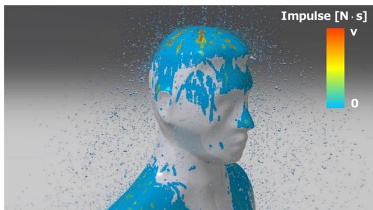
TOTO独自開発ソフトを用いて「富岳」で計算したオーバーヘッドシャワーの人体への吐水の様子と表面の力積分布のシミュレーション結果
