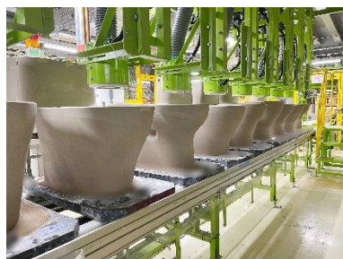
搬送ライン 工程間は、自動化されたラインで生産品 を搬送
