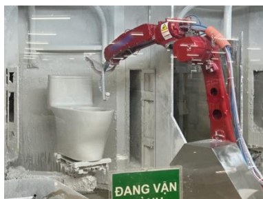
施釉ロボット 衛生陶器に色とツヤを出す「釉薬」を吹き 付けるロボット
