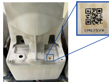
高温に耐える2次元コード 約1,200度に耐える2次元コードによる生産 品の個体識別システムを導入
