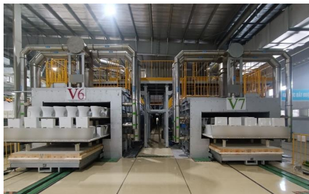
窯の出口 エネルギー効率の高い最新鋭の高効率焼成窯を2基備える
