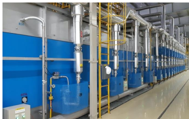
窯の側面 窯の全長は約120m。最高温度約1,200度で焼成する
